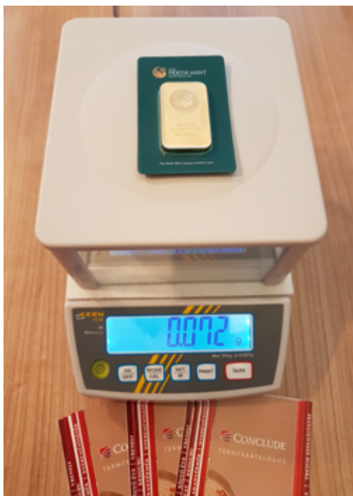
Arany valódiságvizsgálatára szolgáló mágnesmérleg
